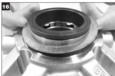
Fjern pakningen fra adapteren og avhend.
